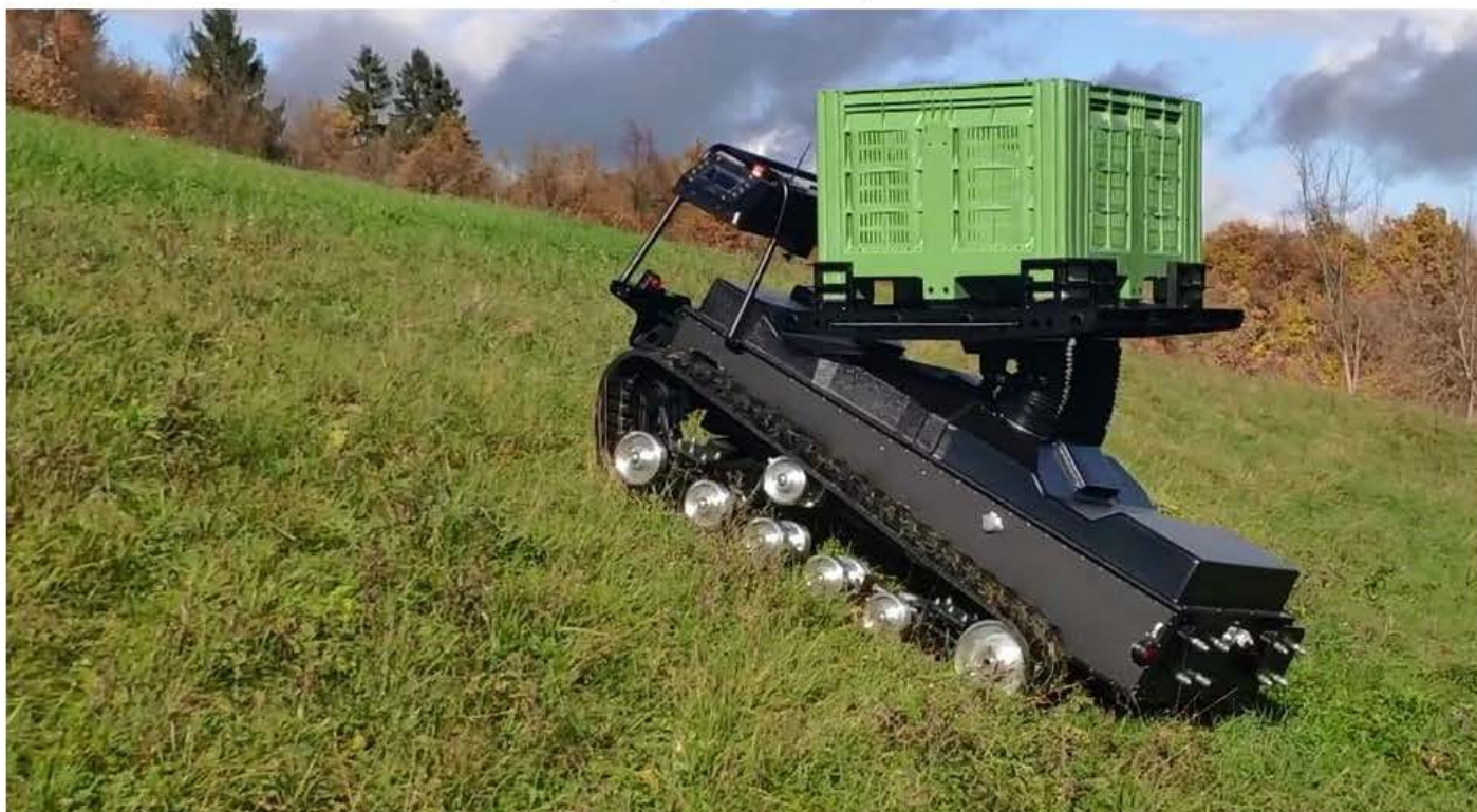
Slopehelper supera il 40% delle pendenze e questo aiuta anche il trasporto della frutta in aree impegnative
