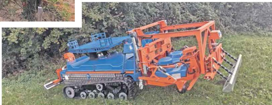
Decembra je bila prva javna predstavitev slopehelperja za domačo strokovno javnost. Gre za avtonomni traktor gosenične izvedbe, namenjen za samostojno delo v vinogradih. Tudi njegovi priključki so električno gnani. FOTO: SAŠO KUZMANOVSKI
